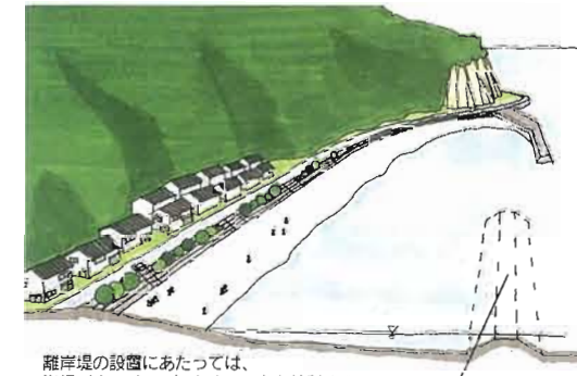
離岸堤の設置にあたっては、潜堤（人工リーフ）とすることも検討する
