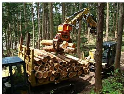
新たに開設した作業道を活用した搬出間伐
