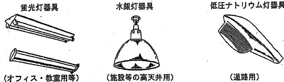
●具体的には、安定器の種類によりPCBコンデンサが使われています。
