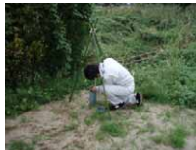
湧水量、地下水位を測定して環境保全施設をつくるための基礎データを収集しています。(H19.9～)
