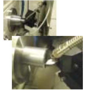
アクリル製フレネルレンズの加工
