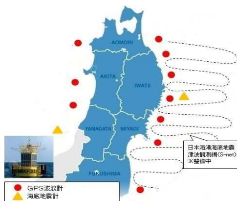
GPS波浪計及び海底地震計設置状況
