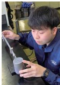
私は現在、一人前の泥水技術者を目指してアシスタントとして現場でのエンジニアリング経験を重ねています。現場では泥水のサンプリングを行い、掘り進めるにつれ変化する性状に合わせて調剤剤を選定します。
