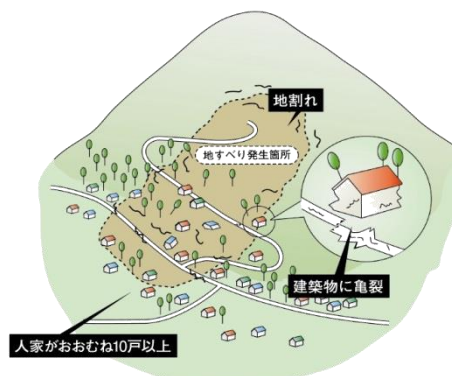
緊急調査のイメージ(地すべり)
