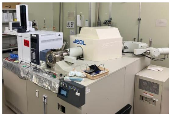
高分解能ガスクロマトグラフ質量分析装置(GC/HRMS)
