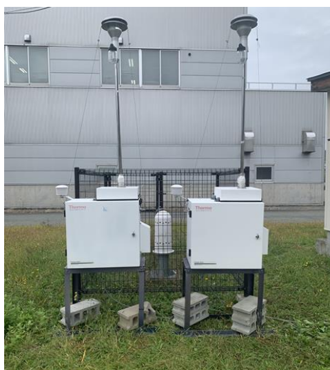
図2 PM2.5試料採取の様子
