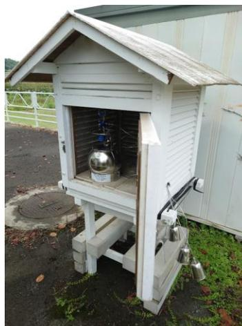
図2 VOC調査の試料採取の様子
