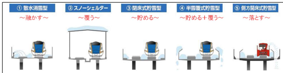
図 北陸新幹線(長野・金沢間)の雪害対策
