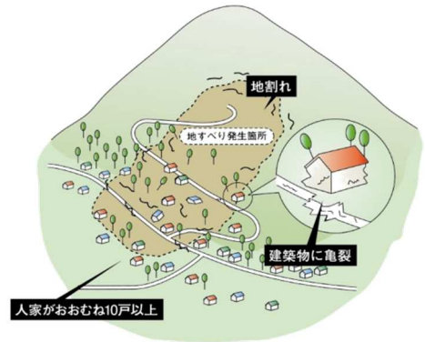
緊急調査のイメージ(地すべり)
