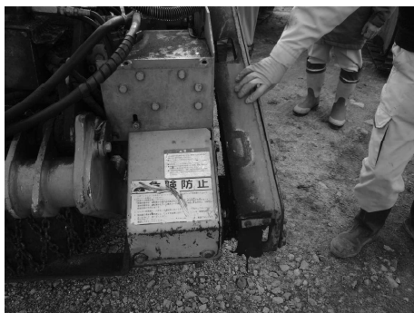
高性能林業機械メンテナンス研修 (R6) 鋸断装置のカバーが割れて外れていた
