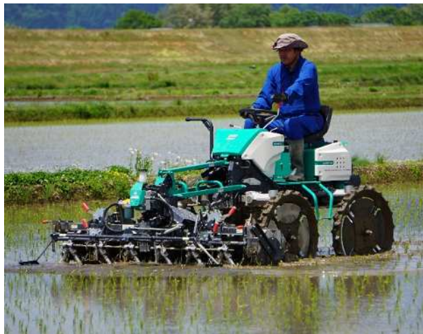
最新の除草機、前側の爪で起こし、浮いた雑草を取る
