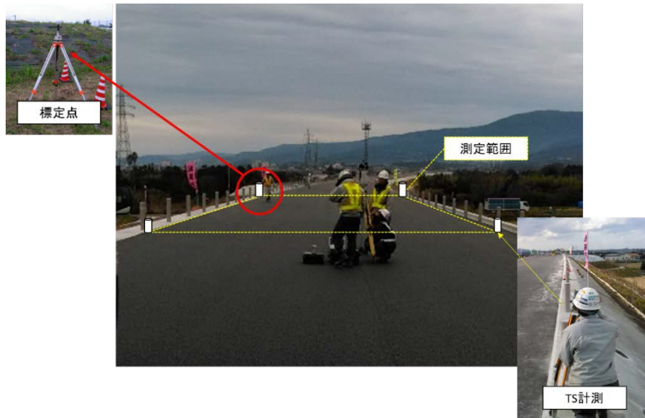
図 3-2 5 T L S と標定点の配置（例）
