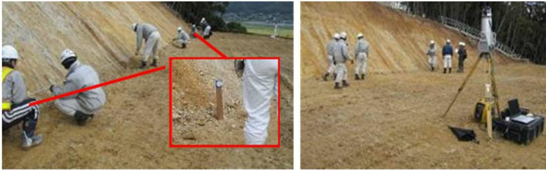
計測方法：テープ or TSによる座標間距離 or TSによる座標値計測
