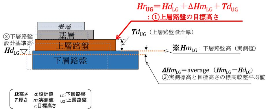
図-3 目標高さ (例: アスファルト舗装)
