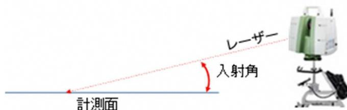
図 4－1 地上移動体搭載型LSの位置と計測面との入射角
