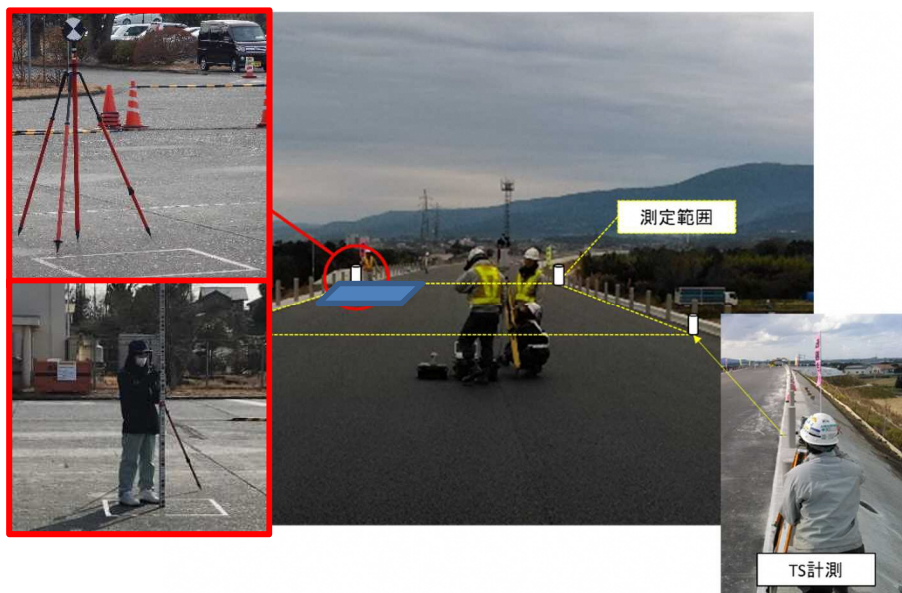
図4-4 地上移動体搭載型LSと検査面・検証点の計測（例）
