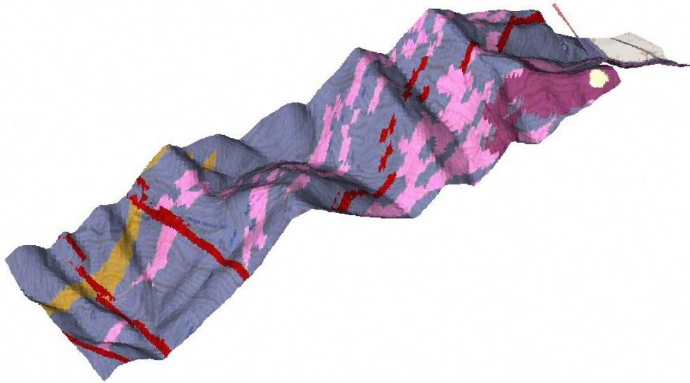
テクスチャモデル（準3次元地質平面図）（数値標高モデルとの合成モデル） （表 19 中 詳細設計のための調査 ①テクスチャモデル（準3次元地質平面図）に該当）
