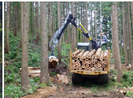
フォワーダ（積載集材車両）
