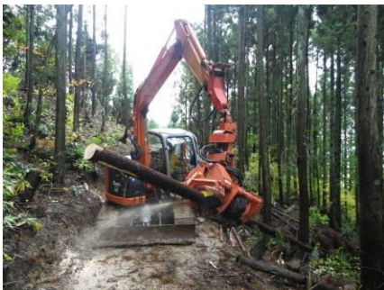
ハーベスタ（伐倒造材機械）
