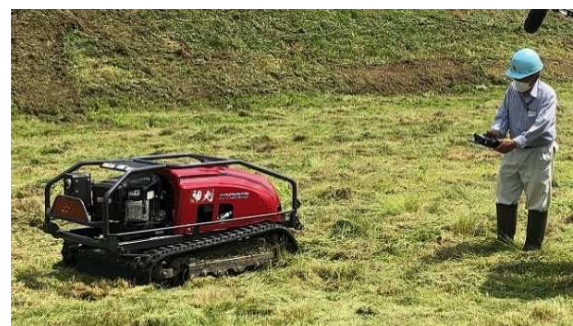
自走式草刈機での作業状況
