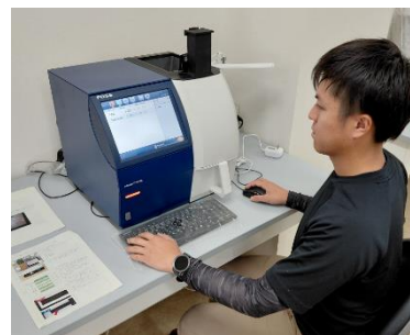
近赤外線分光分析装置 (非破壊で効率的に食味成分含有量を測定)
