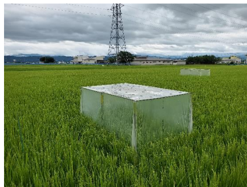
小型ビニールハウスによる高温条件の再現
