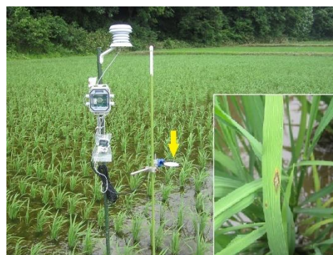
葉面濡れセンサー（↓部分）設置の様子 とイネいもち病の病斑（右下）
