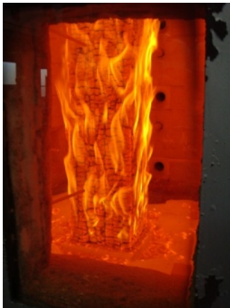
(試験中の耐火部材)
