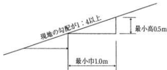
図1-3 盛土基礎地盤の段切
