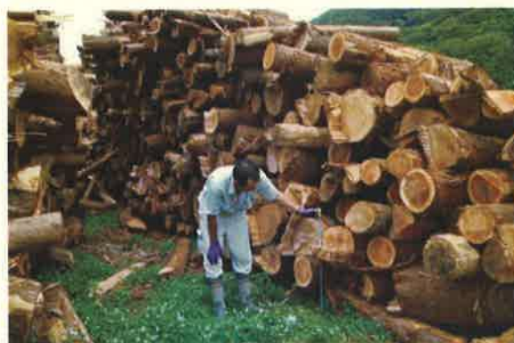
サンプル No.2,3保管状況 (敷砂利棧木高約25cm)
