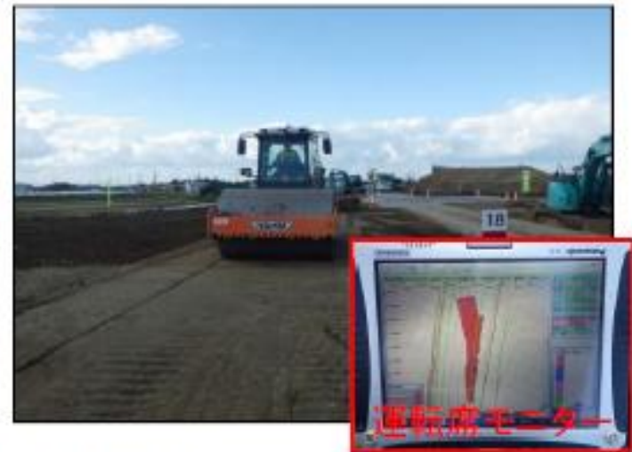
転圧管理システム搭載のローラー施工
