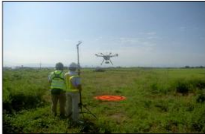
UAVによる施工前の空中写真測量
