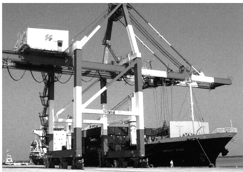
〈ガントリークレーンとコンテナ船〉
