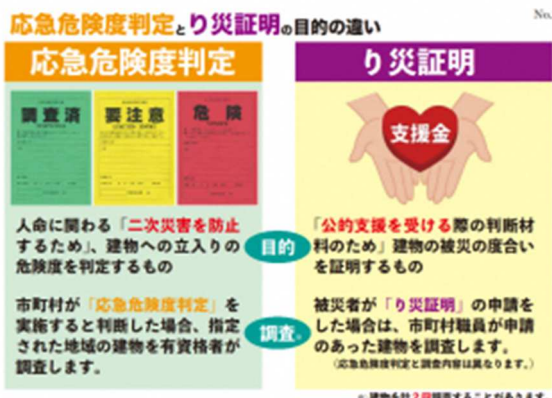
図：応急危険度判定と罹災証明の目的の違い （神奈川県耐震セミナー 展示パネルより）
