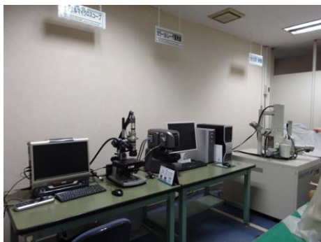
検査室です。めっきしたものの外観を検査し、剥がれ、割れなどを検査します。
