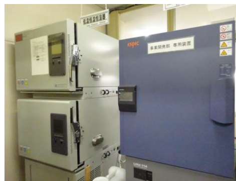
低温恒温恒湿器です。めっきしたものは過酷な環境に置かれることも多いので、めっきしたものが温度変化に耐えられるか、塩水をかけても錆びないかなどを確認します。
