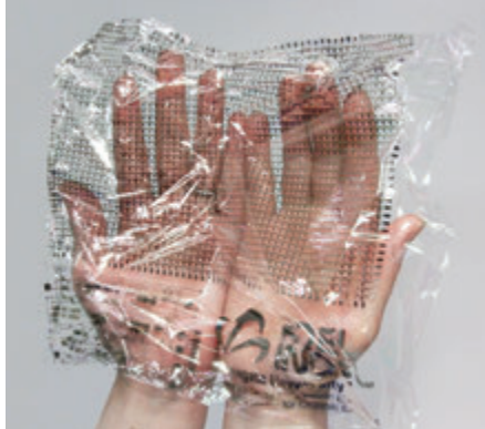
世界初の印刷で作ったトランジスタ
