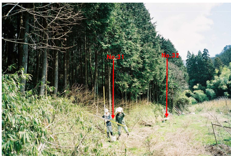
断面－31～断面－32付近の斜面状況 緩勾配の斜面であり、階段状の地形を呈する。 現地確認において斜面勾配は全体に30°未満と判断した。
