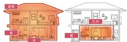
【全体断熱改修】
