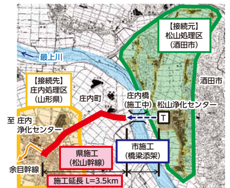
広域化のための管路整備(酒田市松山地区の流域下水道編入)
