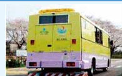
空洞探査車による路面下空洞調査の例 (国土交通省HPより)
