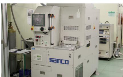
反応性イオンエッティング装置（シリコン、ガラス等の異方性ドライエッティングが可能）
