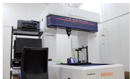
金型や製品などの寸法や形状を1μmよりも高い精度で測定する
