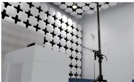
電子機器が電磁波による誤作動を起こしたり、他の製品に影響を与えないかを試験する
