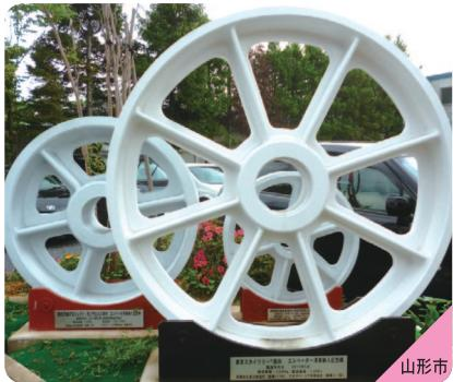
950年の歴史を持つ山形鋳物。その伝統技術が進化し国内で稼働するエレベータの滑車を製造。世界一高い電波塔のエレベータの技術を支える滑車も提供。
