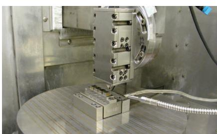
橿円振動切削装置（ダイヤモンド切削工具で鉄系材料に切削加工が可能）
